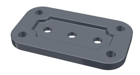
In jedem *Bogenmittelpunkt (Arc Center)* der *Bohrungen (Holes)* wird ein assoziativer *Punkt (Point)* erstellt. Ändert man die Höhe des *Körpers (Bodies)*, geht der *Punkt* mit, die Z-Koordinate passt sich an.
