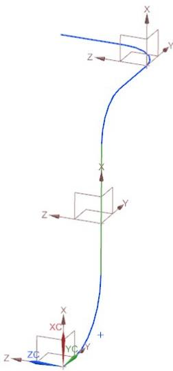
Um mehrere Radien von einem Wert abhängig zu machen, erzeugen wir eine Verbindung zu einer Variable (**Rvariable**). Hierzu müssen wir in die *Ausdrücke* (<STRG> + E) und einen neuen *Ausdruck* erstellen und diesen in die Formel der Radien eintragen (Hierbei können auch Gleichungen mit der Variable erstellt werden z.B. „**Rvariable \* 1.5**“)
