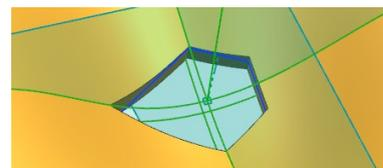
Es wurde eine *Bohrung (Hole)* erzeugt, die stets senkrecht zur frei geformten Oberfläche ist. Der Durchmesser lässt sich beliebig über die *Parameter* oder der *Skizze (Sketch)* steuern.
