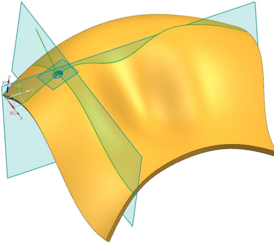
Mit einer Bewegung der beiden *Bezugsebenen (Datum Plane)* lässt sich die Position der Bohrung steuern.
