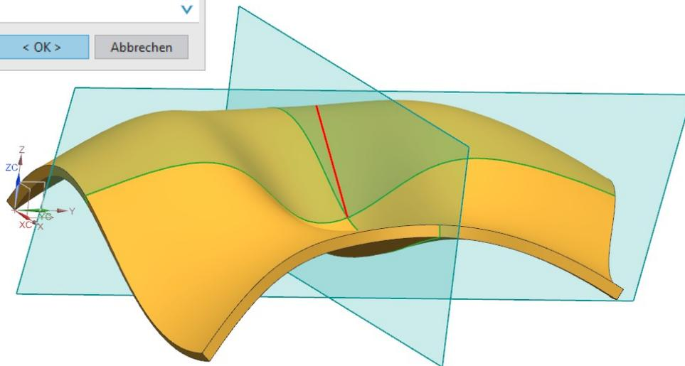
Am Berührungspunkt dieser neuen *Linie (Line)* mit dem Körper wird eine weitere *Bezugsebene (Datum Plane)* erzeugt, die senkrecht zur *Linie* steht.
