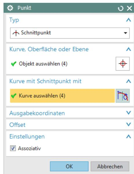
Die *Flächennormale* wird als *Linie (Line)* erzeugt. Als *Startoption (Start Option)* der *Linie (Line)* dient der zuvor erzeugte *Punkt (Point)* und als *Endoption (End Option)* wird die orangene Körperoberfläche angewählt.
