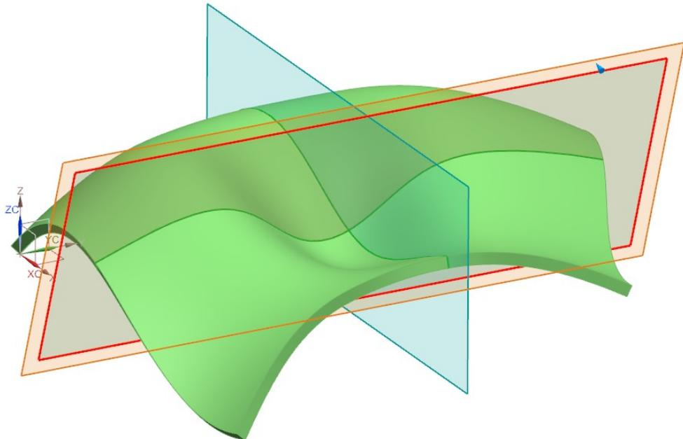
Auf dem Schnittpunkt der beiden grünen *Schnittkurven (Intersection Curves)* wird nun ein *Punkt* erstellt. Dieser dient später als "Befestigungspunkt" für eine *Flächennormale (Linie)* bzw. eine *Skizze (Sketch)*.
