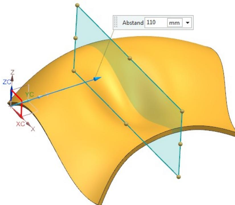
Nun wird eine *Schnittkurve (Section Curve)* zwischen der zuvor erzeugten *Bezugsebene (Datum Plane)* und dem Körper erstellt. Durch eine Veränderung des Abstandswertes der *Bezugsebene* kann diese *Schnittkurve* bereits assoziativ über den Körper geschoben werden.
