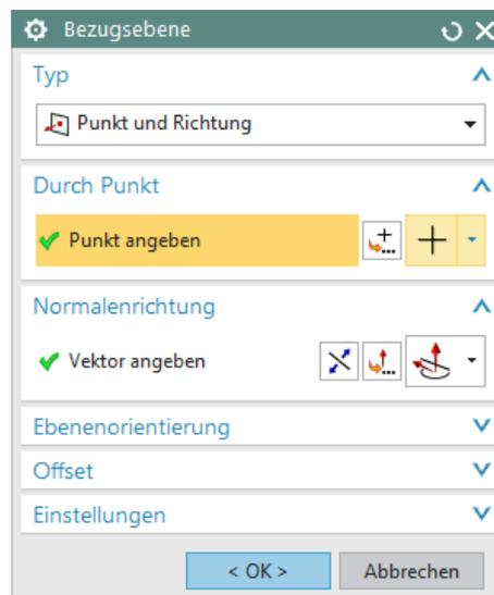
Auf dieser *Bezugsebene (Datum Plane)* wird nun eine *Skizze (Sketch)* platziert, die lediglich aus einem *Kreis (Circle)* besteht wo der Durchmesser bemaßt wird.
