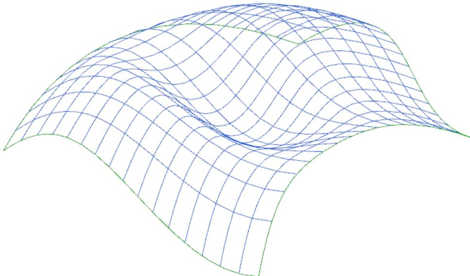
Die Fläche wird zu einem *Körper (Solid)* mit einer konkreten Wandstärke aufgedickt, in diesem Beispiel (5 mm).
